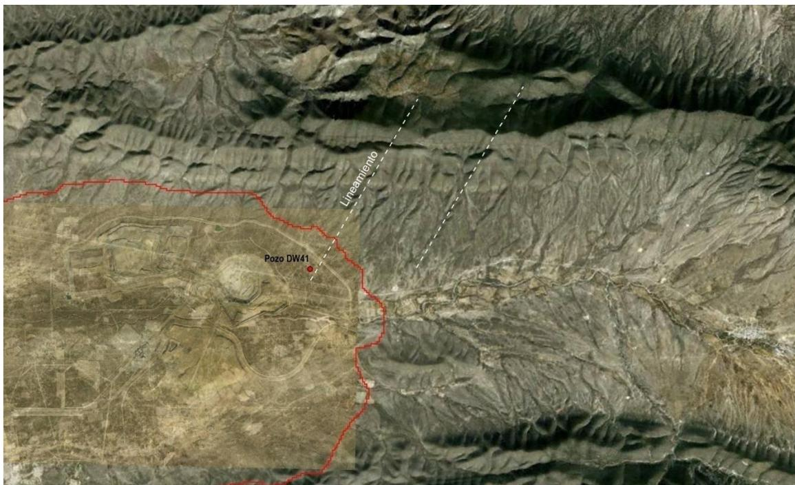
**Figura 4.9** Imagen de satélite del valle de Mazapil que muestra el lineamiento asociable con la falla que afecta al pozo DW41. Se observa que la misma dirección del lineamiento se repite en el valle.
